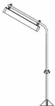
Instalação com luminária linear - CALH
